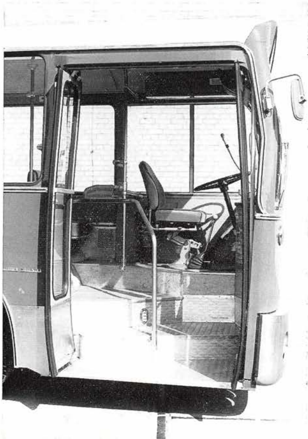
Breiter bequemer Einstieg mit 325 mm Einstiegshöhe. Mit zwei Zwischenstufen ergibt sich eine Bodenhöhe von 725 mm.
