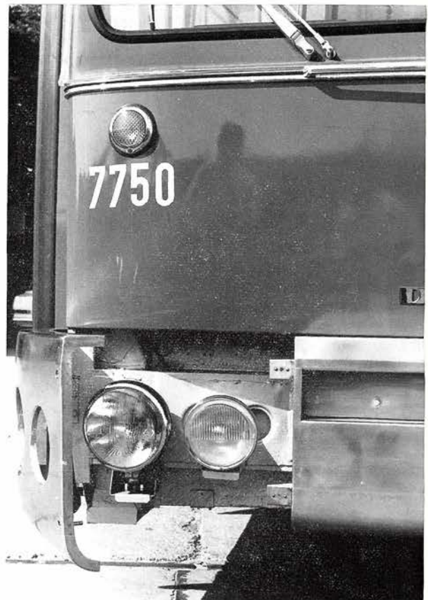
Scheinwerfer und Nebellampen sind nicht unmittelbar in die Stoßstange eingebaut, sondern frei dahinter
