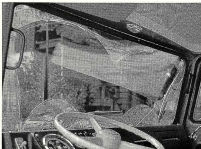
Abb. 10: Die beiden Scheibenwischer halten praktisch die ganze Windschutzscheibe frei.
