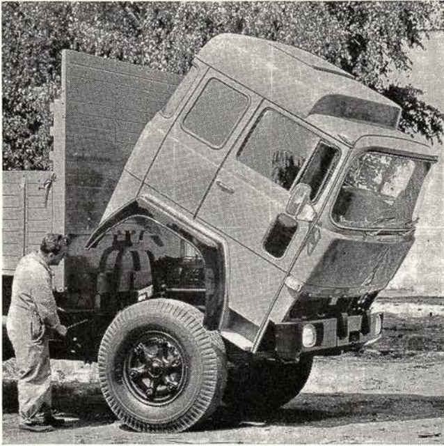
Das Fahrerhaus wird gekippt, der Fahrer betätigt die Pumpe
