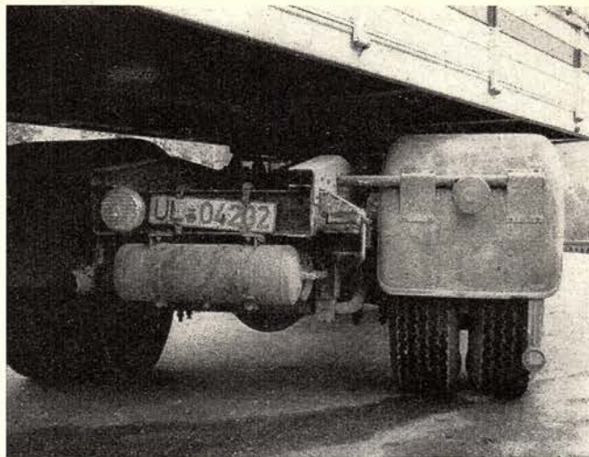
Die Zugmaschine hat an der Hinterachse lange, einteilige Blattfedern, die durch Abwälzblöcke eine progressive Charakteristik beim Durchfedern erhalten. Ein Querneigungsstabilisator wurde durch diese weichen Federn allerdings notwendig
