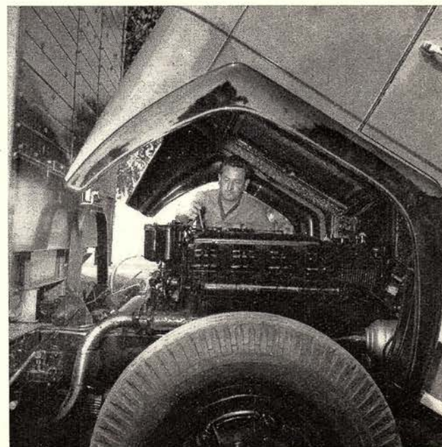
Diese Wartungs- und Reparaturstellung des vorkippbaren Fahrerhauses wird in wenigen Sekunden nach Entriegeln des Fahrerhauses vom Innern her und nach Betätigen der kleinen Handpumpe unten links im Bild erreicht. Zur Motordemontage ist die Stoßstange abzuschrauben und das Lenkgetriebe zu lösen, wonach das Fahrerhaus weiter vorgekippt werden kann
