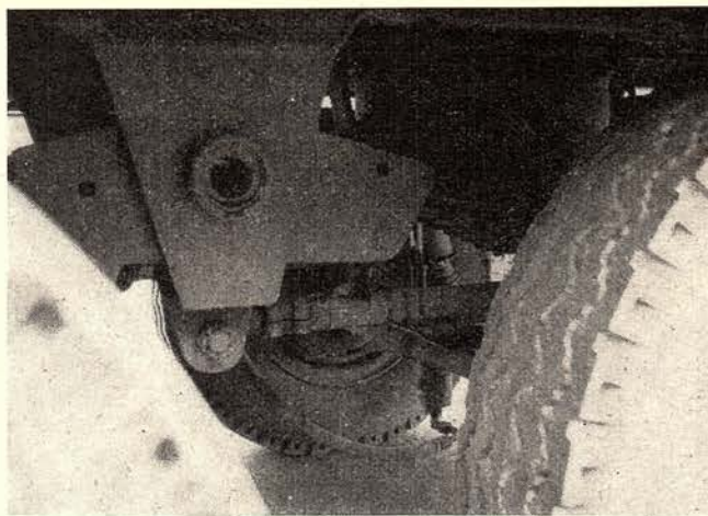
Die drei Achsen des Kugel-Sattelaufhängers haben untereinander einen Federhöhenausgleich. Alle Gelenke haben Gummi-Silentlager. Die hintere Achse ist eine selbstspurende achsschenkelgelenkte 6-t-Tragachse, die bei Rückwärtsfahrt, vom Fahrerhaus aus bedient, angehoben werden kann
