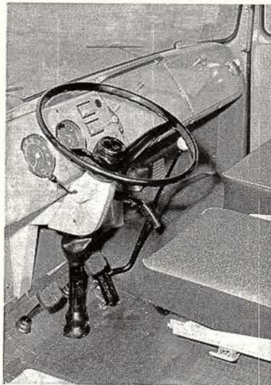
Magirus hat nunmehr bei den Fahrzeugen mit 7,5t und 9t Gesamtgewicht eine raumsparende und die Sicherheit fördernde geknickte Lenksäule sowie eine größeres, schlüsselförmig ausgebildetes Lenkrad eingebaut. Die Anordnung von Schalthebel und Handbremse gestattet dem Fahrer den freien Durchstieg zur rechten Fahrzeugseite hin.
