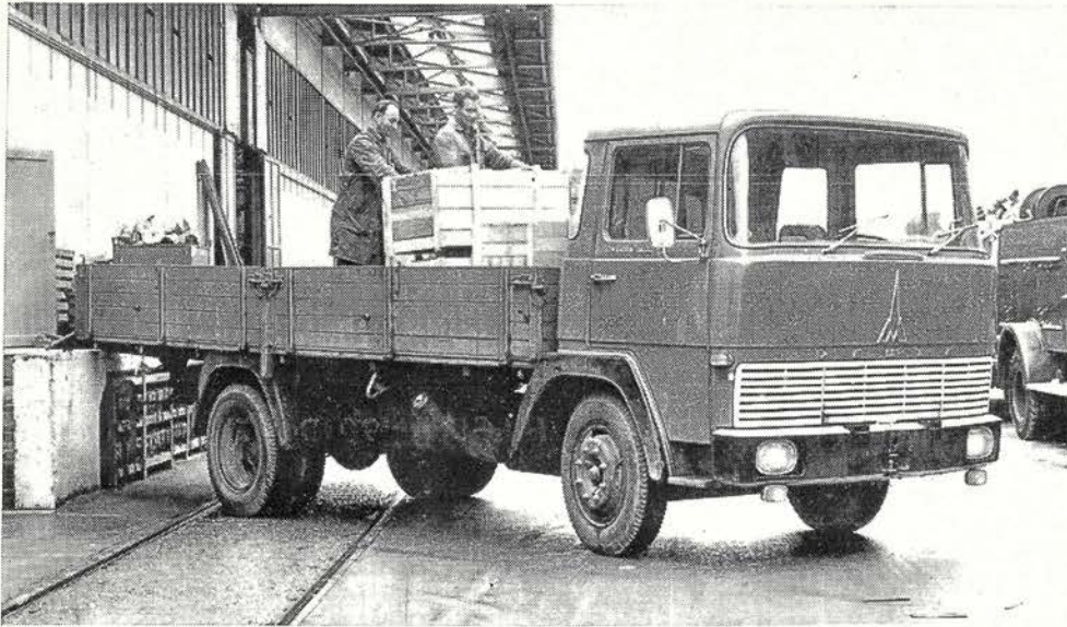
Der Magirus-Frontlenker-Lkw vom Typ 100 D 7 FL ist für ein zulässiges Gesamtgewicht von 7,45 t ausgelegt. Das Fahrzeug hat das neue Einheits-Fahrerhaus und als Antriebsaggregat den luftgekühlten Deutz-Dieselmotor vom Typ „F 6 L 812 D“
