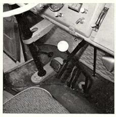
Die Lenksäule ist am Armaturenbrett gelagert, und gegenüber früher wurde der Schalthebel zweifach gekröpft. So braucht man als Fahrer auch beim Einlegen der vorderen Gangstufen seine Sitzhaltung nicht zu verlassen. Das gelegentliche Kollidieren des Schalthebels mit dem Armaturenbrett ist damit auch behoben. Die serienmäßig vorhandene Zusatzheizung dient zur Temperierung des Fahrerhauses.
