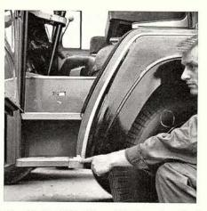
Obwohl die Trittstufen nicht besonders breit sind, vollzieht sich der Einstieg in den Magirus ausgesprochen bequem und leicht. Die untere Trittstufe liegt frei im Fahrtwind und ist gleichsam den Unbilden der Witterung ausgesetzt. Das hat Magirus bewogen, zwischen Trittstufe und Kotflügel ein Gummiprofilstück einzusetzen, um die Verschmutzung der Seitenscheiben und der Außenspiegel bei Regen zu verhindern.
