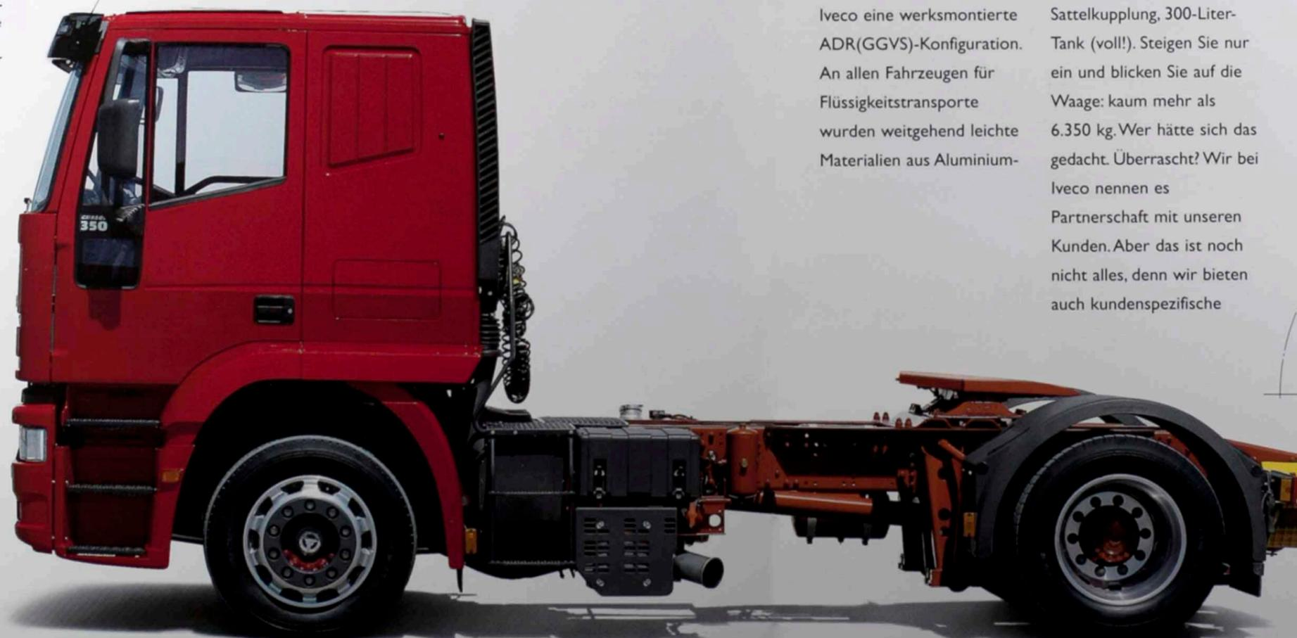
Rahmen, Getriebe, Achsen und Halterungen für die funktionalen Komponenten wurden dort in ihrer Größe verändert, wo sie der geringsten Belastung ausgesetzt sind, um das Leergewicht zu reduzieren, ohne Einbußen bei Stabilität, Geräumigkeit des Fahrerhauses oder Umfang der Serienausstattung machen zu müssen. Für den Gefahrguttransport bietet Iveco eine werksmontierte ADR(GGVS)-Konfiguration. An allen Fahrzeugen für Flüssigkeitstransporte wurden weitgehend leichte Materialien aus Aluminium-
