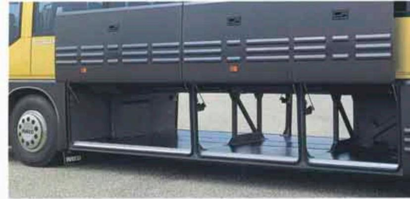
Großer Gepäckraum mit zentralverriegelten, nach oben aufschwingenden Klappen ohne behindernde Einbauten.
