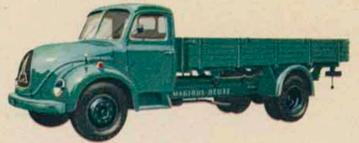
Der vielseitig verwendbare SIRIUS Lastkraftwagen für den Nahverkehr; 3,5 bis 4 t Nutzlast, Pritschenlänge 4,25 und 5,5 m.
