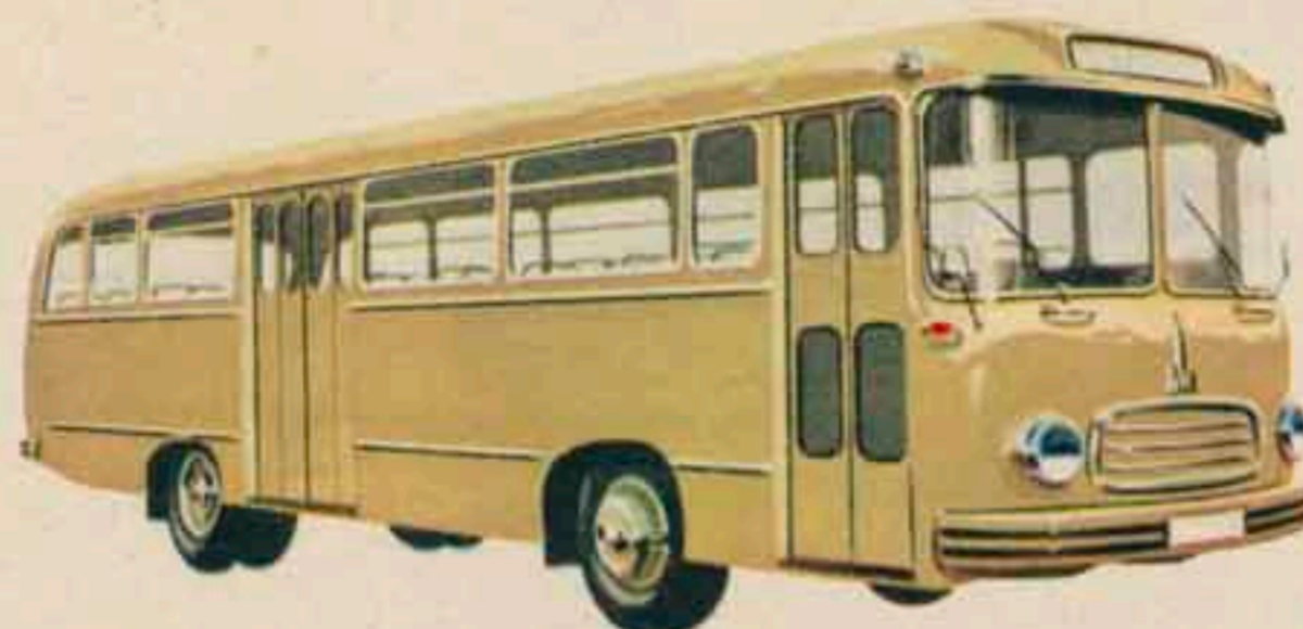
Der Stadtverkehrsomnibus SATURN II, gefertigt nach den neuesten Erkenntnissen im Omnibusleichtbau; mit Luftfederung; mit Deutz-Diesel-Heckmotor 125 PS; Fassungsvermögen bis 100 Personen.
