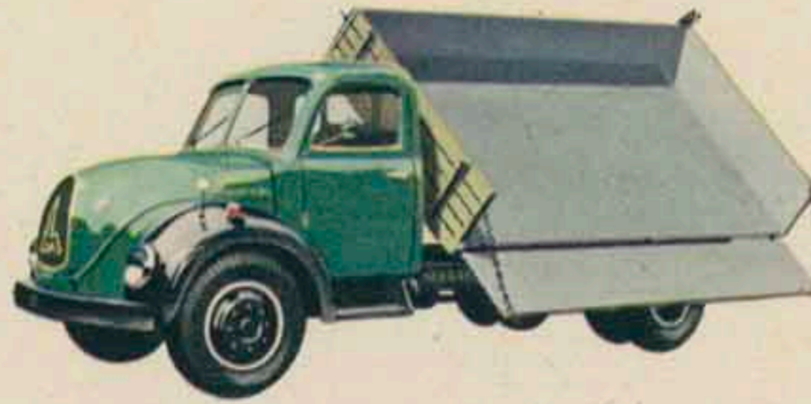
SATURN Dreiseitenkipper, wie alle Magirus-Deutz Nutzfahrzeuge mit einem kräftigen Aufbau für harten Dauerbetrieb; verstärkt bis 6,5 t Nutzlast.
