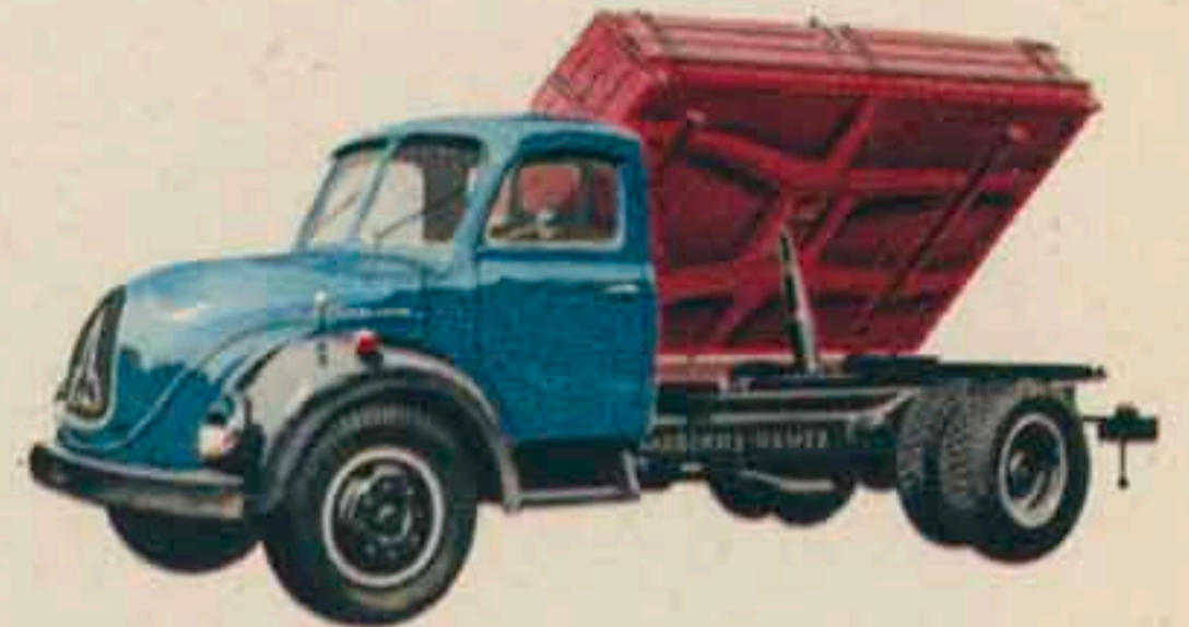
SIRIUS Dreiseitenkipper, der robuste Kipper der 3,5-Tonner-Klasse; bis 3,9 t Nutzlast, Radstand 3700 mm, mit 85 PS Deutz-Dieselmotor.
