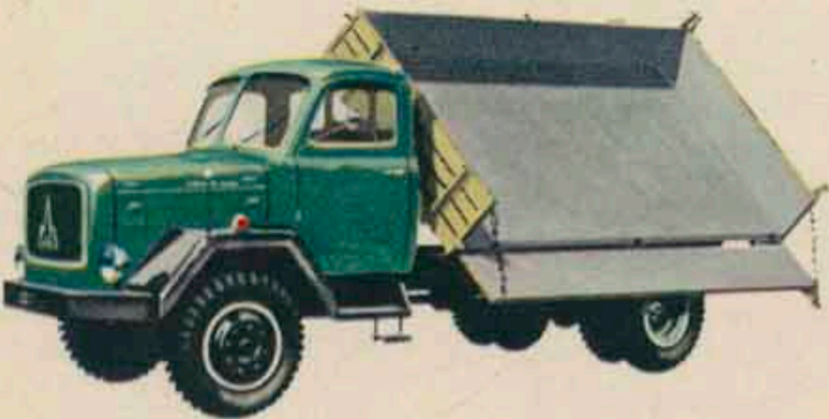
Eine Lücke in unserem Allradfahrzeug-Programm schließt der neue SATURN A mit dem bewährten 125 PS Deutz-Diesel-V-Motor. Bei günstigem Eigengewicht wurde eine Nutzlast von 6,3 t erreicht.
