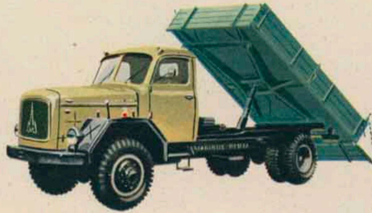
Allradkipper vom Typ JUPITER A, ausgerüstet mit dem luftgekühlten 170 PS Deutz-Diesel, können auf Wunsch auch mit einer Kippmulde oder mit einem Spezialaufbau geliefert werden.
