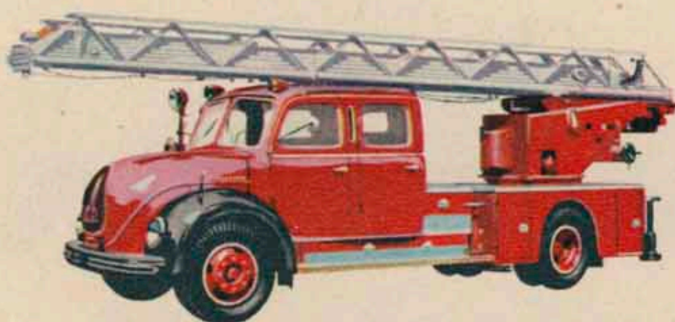
Hydraulische Kraftfahrdrehleitern DL 25 h und DL 30 h
