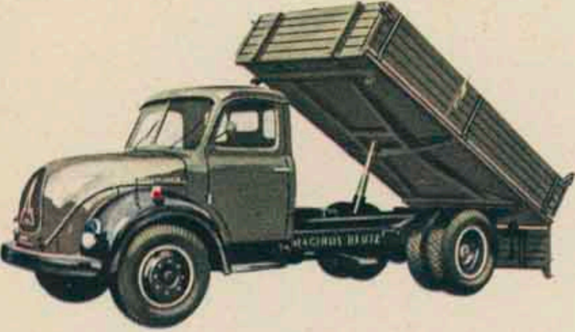
Dreiseitenkipper MERCUR, MERCUR 112 und MERCUR 125, mit Deutz-Dieselmotoren 85 PS, 112 PS bzw. 125 PS Leistung; Nutzlast 4,85 bis 5,2 t; Pritschenlänge 3,20 bis 3,80 m.
