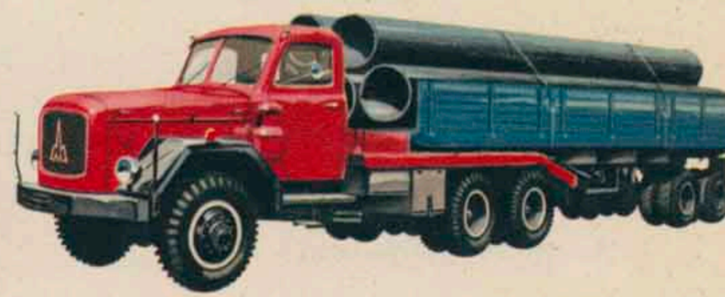
Allradfahrzeug Typ URANUS, mit 250 oder 170 PS Deutz-Dieselmotor für Spezial-Transportaufgaben, mit Sonderaufbauten (Kran, Muldenkipper, Abschleppwagen usw.) bis 16 t Nutzlast lieferbar.
