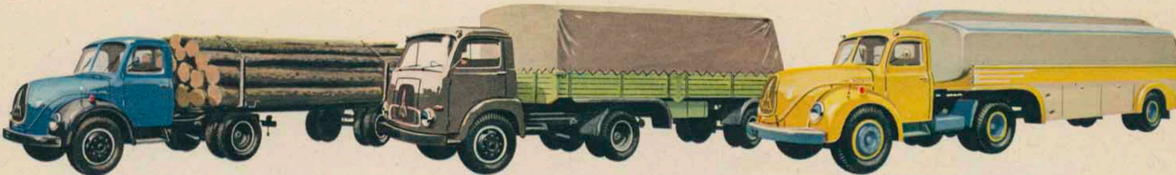
Zwei Sattelzugmaschinen mit Alligatorhaube, MERCUR 125 und SATURN, die sich überall in hartem Dauereinsatz bewährten. Hoher Sattelzugdruck bei Gesamtzuggewicht bis 27 000 kg.
