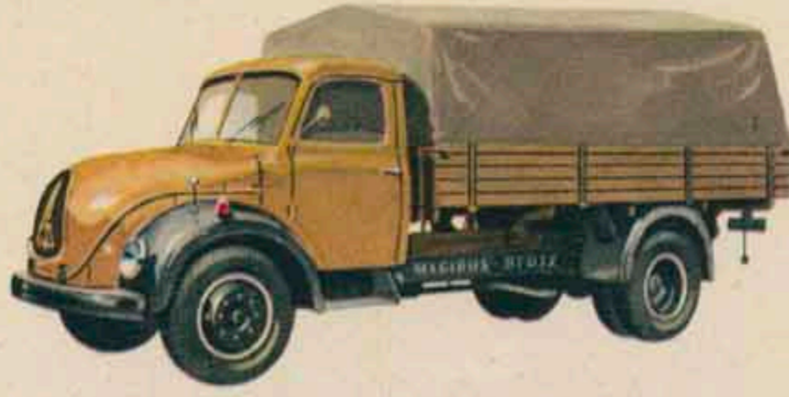
Der neue MERCUR 125 Lastkraftwagen, als 5,5 Tonner mit luftgekühltem 125 PS 6-Zylinder-Deutz-Diesel-V-Motor; Radstand 4200 und 4850 mm.
