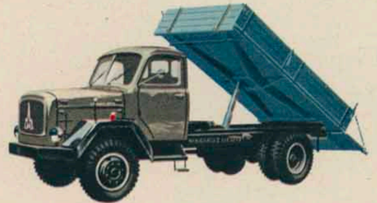
Allradkipper MERCUR A und MERCUR 112 A, die geeigneten Kipper für schwierige Transportaufgaben bei schlechten Wegverhältnissen; Nutzlast 4,7 bis 4,8 t.
