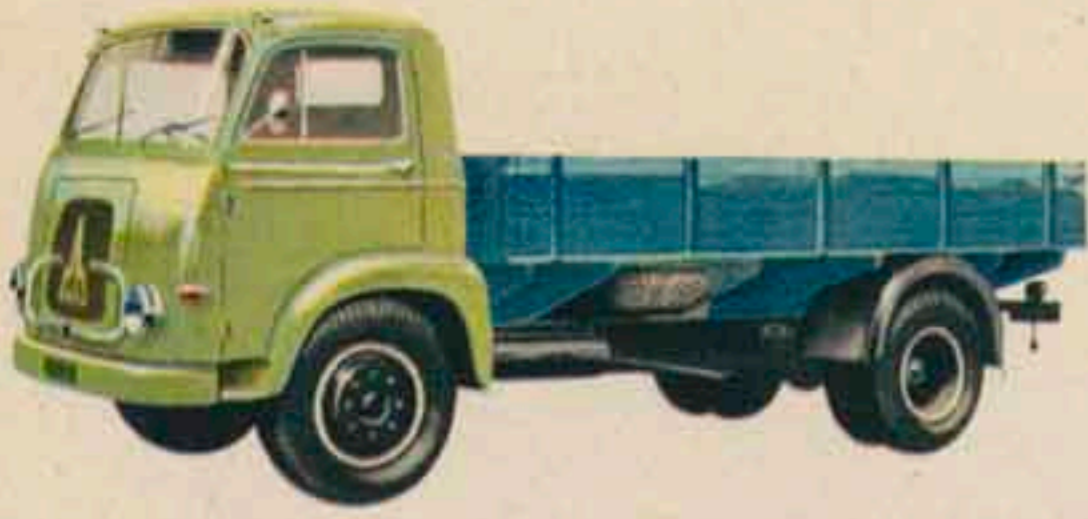
MERCUR F und MERCUR 112 F Lastkraftwagen in Frontlenker-Ausführung; 4,5 bis 5 t Nutzlast; Pritschenlänge bis 6 m; auch als Haubenwagen (MERCUR, MERCUR 112) wie bisher lieferbar.
