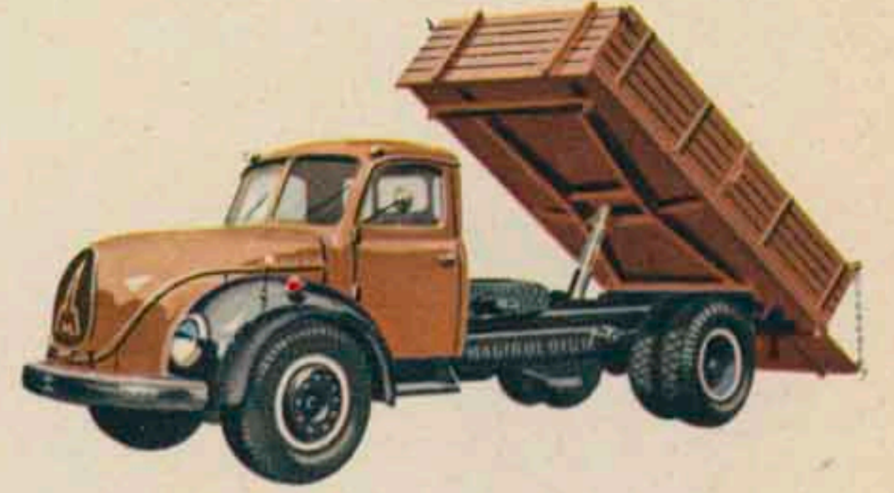
Dreiseitenkipper JUPITER, 8,3 t Nutzlast, Radstand 4400 mm, 170 PS Deutz-Dieselmotor. Der Typ Jupiter ist auch als Lastkraftwagen, mit Radstand 4400 und 4800 mm lieferbar.
