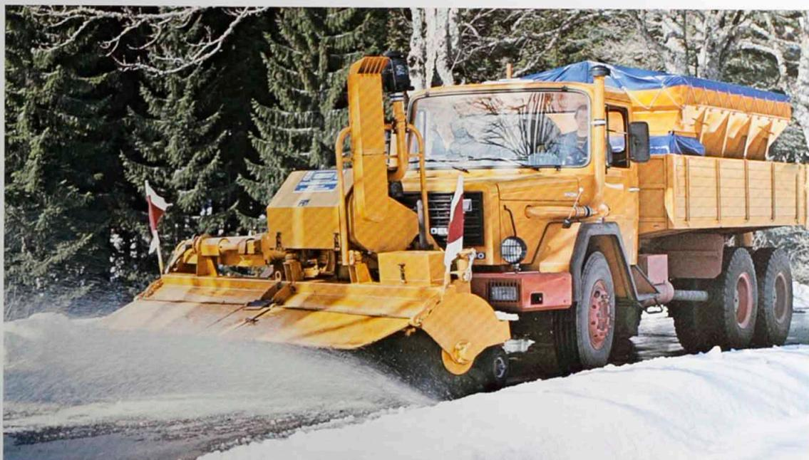
Die patentierte Schnellwechsellvorrichtung ermöglicht einen An- oder Abbau der Maschine in ca. 5 Minuten vom Fahrer allein ohne Hilfsperson.
